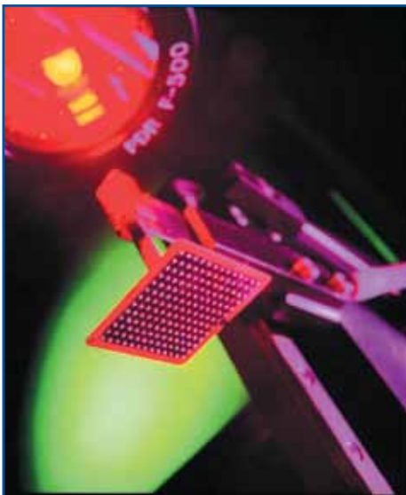
Рис. 4. ИК фокусная пайка на ремонтных центрах PDR
