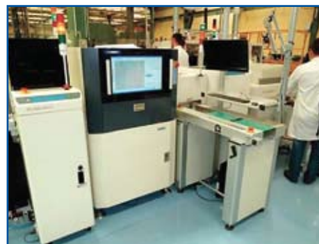
Рис. 8. Система автоматического ремонта с помощью селективной пайки
