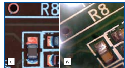
Рис. 4. Вид дефекта: а) при использовании улучшенного 3D-режима; б) полученного в традиционной системе АОИ
